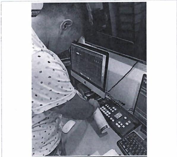
Aplicación de aire comprimido a la mezcladora de video
